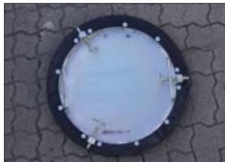
Sie verhindert, dass Schutt, Werkzeuge, etc. in den Kanalschacht fallen sowie das konzentrierte Ausströmen von flüchtigen Stoffen. Die Gummimanßchette am Rand gewährleistet eine gute Anpassung und die Schnellverschlüsse ermöglichen eine zügige Arbeitsweise: Kein unnötiges Einsteigen in den Schacht und das Verhindern der Kanalverschmutzung schützt auch vor Folgeschäden.
