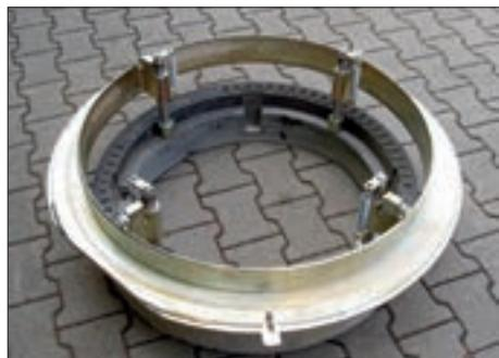
Zum Heben der Schachtabdeckungen nach neu eingebauter Schwarzdecke. Mit automatischer Mittenzentrierung und Höhenanschlägen.
