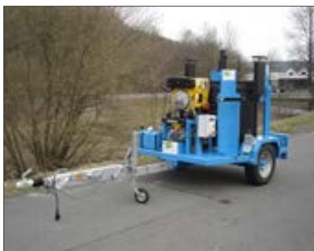
Zum Aufschmelzen und Verarbeiten von thermoplastischen Fahrbahnmarkierungsmassen und bituminösen Fugen- und Schienenverguss- sowie Schienenuntergussmaterialien. Hohe Aufschmelzleistung bei niedrigem Gas- oder Heizölbedarf. Lieferbar sind die Maschinen mit Gas- oder Ölfeuerung. Mit vertikalem Rührwerk hydraulisch angetrieben und hydraulischen Schaltventilen. Brennerleistung: 50 kw Nutzinhalt 180 bzw. 250 Liter.
