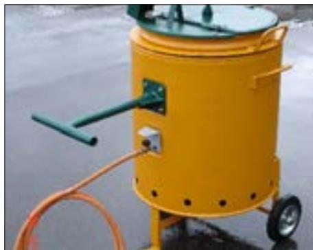
Zum Aufschmelzen von bituminösem Fugenvergussmaterial.
