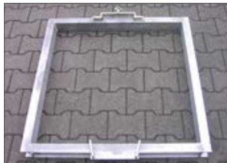
Zum Heben von Schachtrahmen mit quadratischer Außenkontur.
