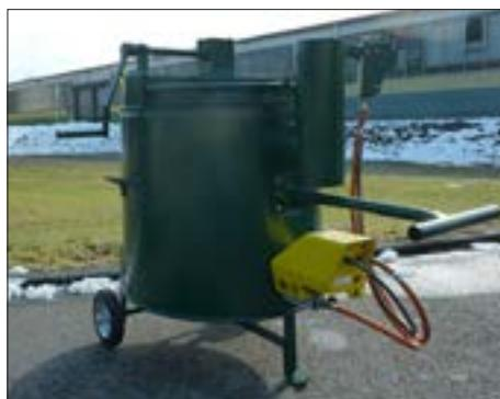
Die Geräte werden zur Verarbeitung von gefüllten Bitumen- und Spachtelmassen eingesetzt. Direkte Beheizung für eine schnelle Erhitzung der Aufschmelzmasse. Temperaturregelung für Schmelzgut und einer Sicherheits-temperaturabschaltung.
